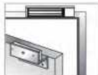
BRACKET TIPO L Y Z Para apertura hacia adentro
